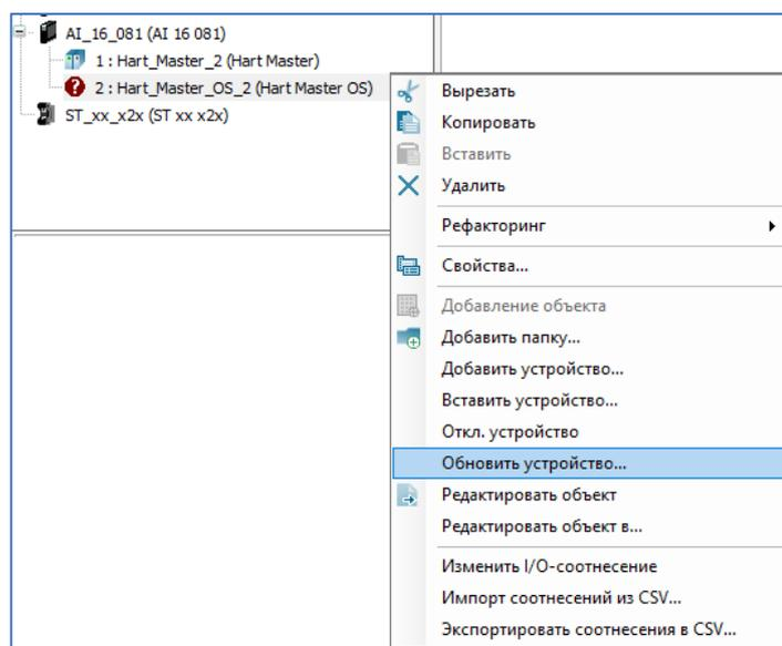
Рисунок 1 – Обновление устройства
