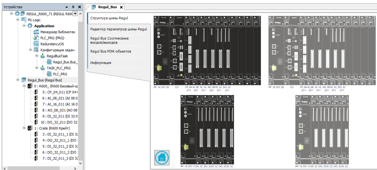
Рисунок 50 – Структура шины контроллера R600 (2 крейта, с полным резервированием)
