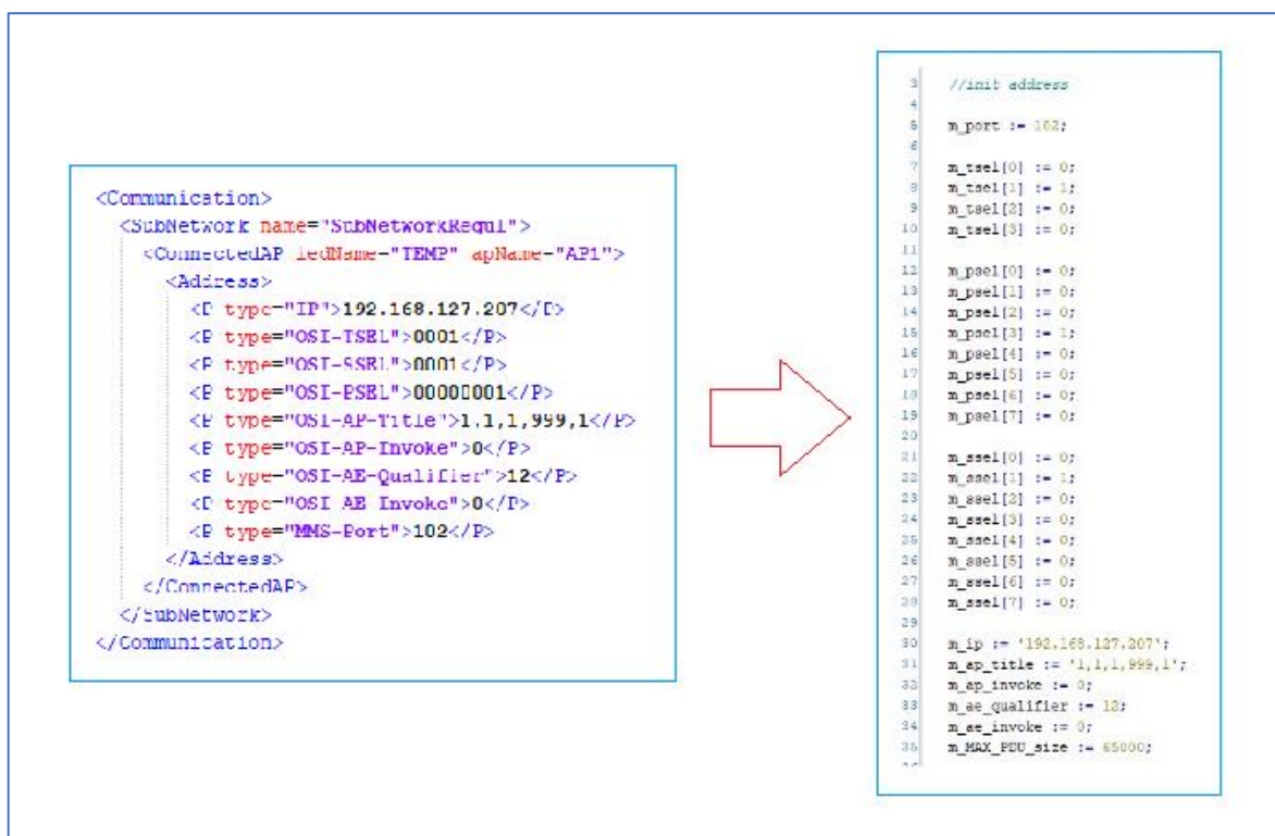
Рисунок 8 – Настройки параметров ассоциации в исходном ICD-файле и в виде сгенерированного кода
