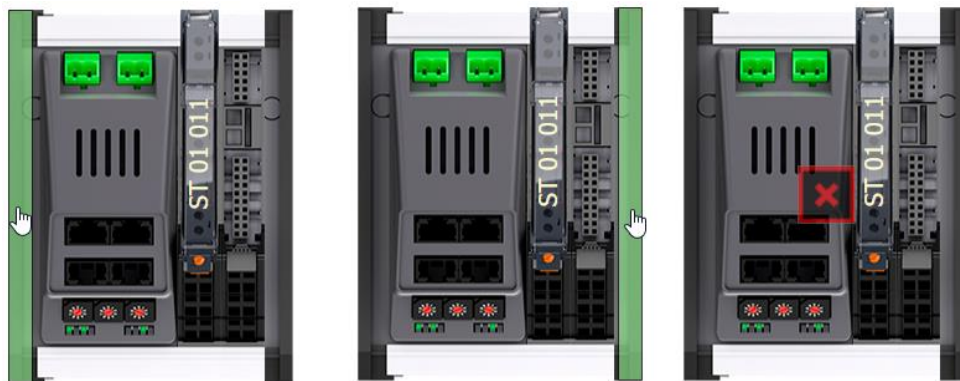
Рисунок 66 - Добавление модулей слева/справа и удаление в редакторе крейта R100
