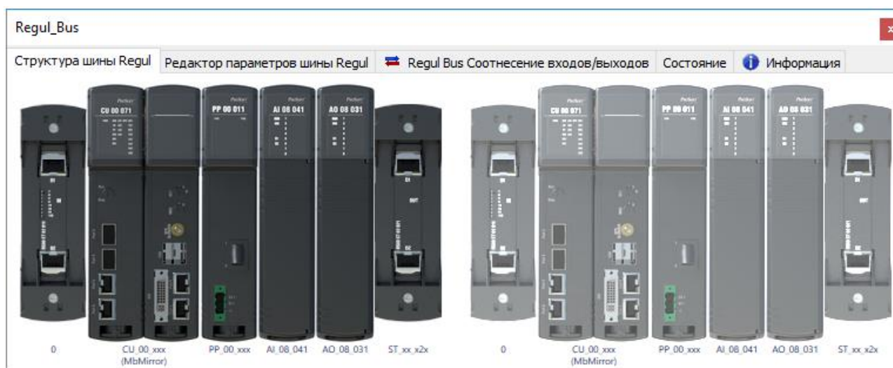
Рисунок 23 – Редактор шины контроллера R500 (схема с полным резервированием)
