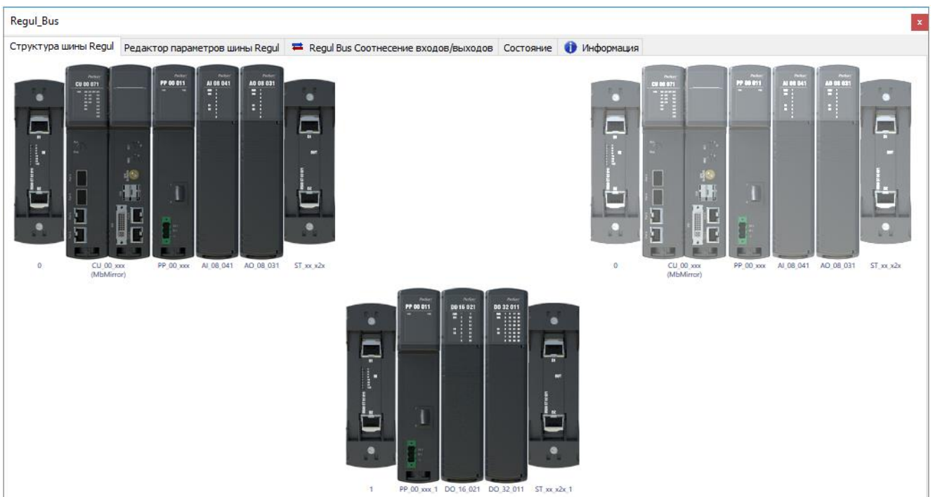
Рисунок 25– Редактор шины контроллера R500 (полное + частичное резервирование)
