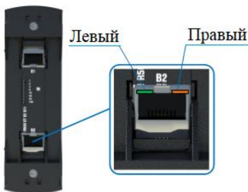
Рисунок 81 - Индикация интерфейса RJ45 модулей ST XX 0XX
